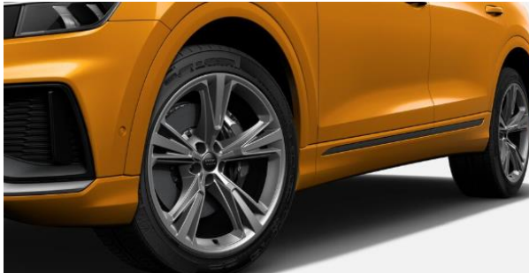
Llantas de aleación de aluminio tamaño 10Jx21, diseño de 5 radios segmentados, con neumáticos 285/45.
